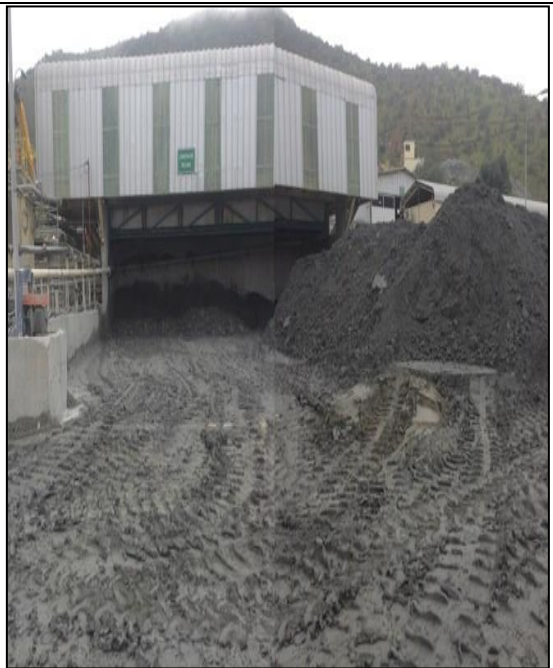
Foto 13: Sector losa de relaves con acumulación de relave filtrado antes del reinicio de las operaciones de carguío y transporte
